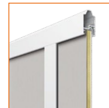
Doppelwandig, geschlossene Füllung, Sandwich-Aufbau (20 mm), außen Alu-Glattblech, innen Stucco-Design
