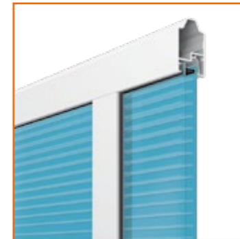
Fünfkammer-Stegplatte, Polycarbonat (20 mm) blau getönt (38 % Lichtdurchlässigkeit)
